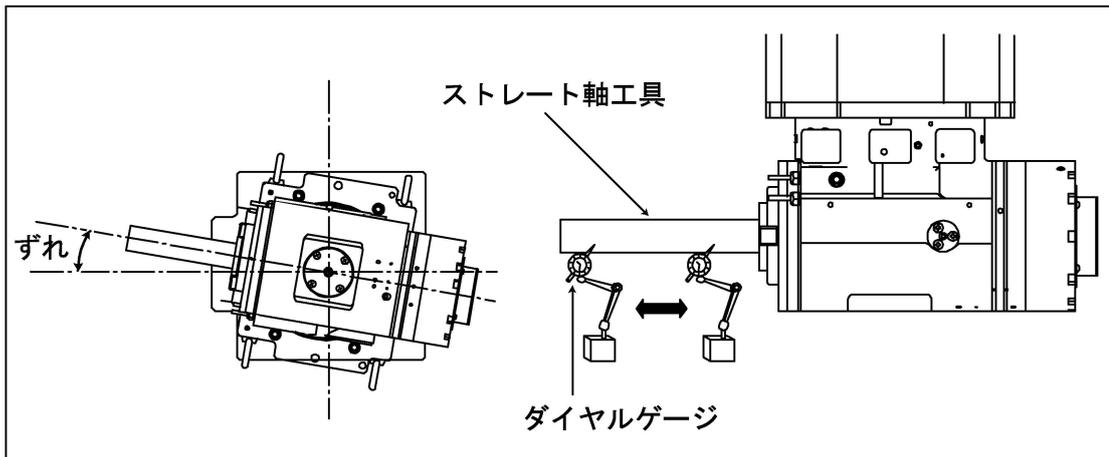
アタッチメントの旋回方向にずれが生じていた場合は、次の手順で偏芯ブッシュを調整し、ずれを修正してください。
